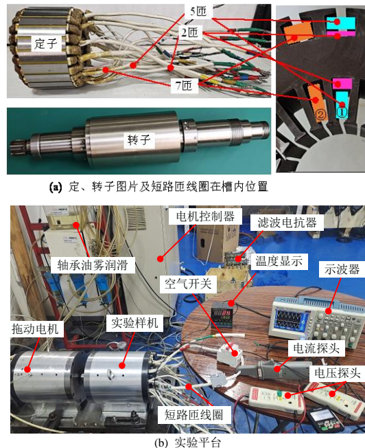
图 18 样机的实验测试平台 Fig. 18 Photos of the test platform of the prototype
